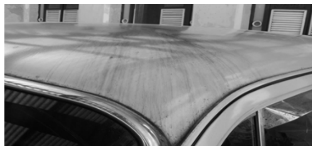
Figura 1. Techo del automóvil de José Antonio Echeverría manchado por celdas de aireación diferencial formadas por goteras.
